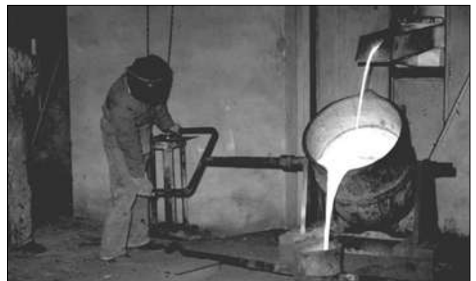
Uitbreken vormen producten en gieten in vormen in gieterij
