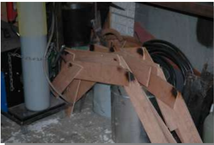
Houten mallen van de spanten
